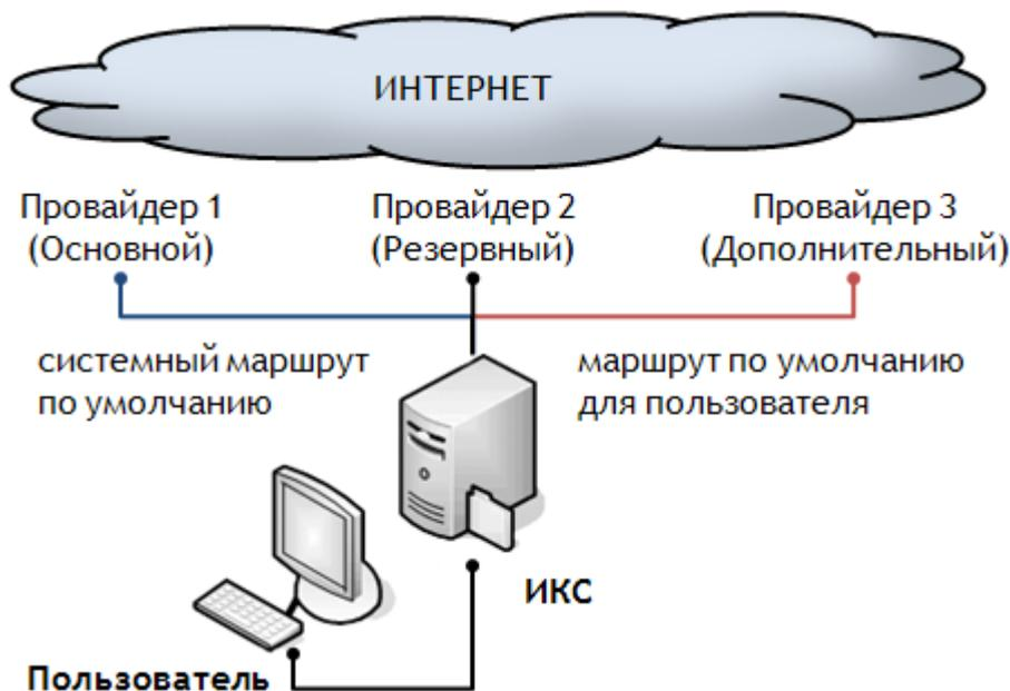
Следующая схема представляет работу трех провайдеров ИКС. Основной Провайдер 1 является шлюзом по умолчанию для всех пользователей и сервисов. Провайдер 2 неактивен до тех пор, пока не пропадет связь с Провайдером 1. Провайдер 3 настроен как дополнительный. Для выделенного пользователя настроен статический маршрут через этого провайдера.
