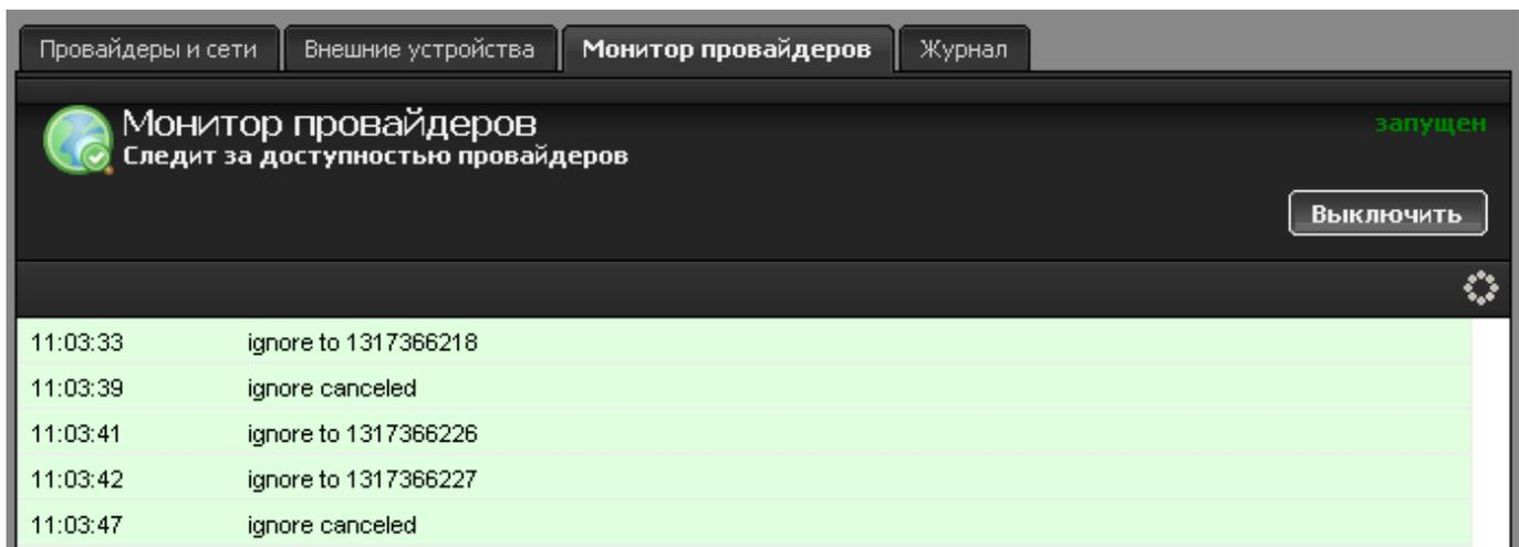
Вкладка «Мониторинг провайдеров» открывает модуль соответствующей службы, который следит за состоянием провайдеров и их переключением. При необходимости эту службу можно отключить.
