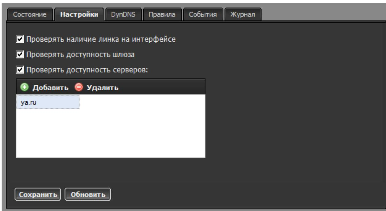
Каким образом ИКС понимает, что основной Провайдер 1 недоступен и пора переключиться на резервного Провайдера 2? Этот критерий определяется в детальных настройках провайдера. Для того, чтобы перейти к ним, необходимо нажать кнопку “Подробно” на нужном провайдере. ИКС может определять доступность провайдера по следующим критериям:
