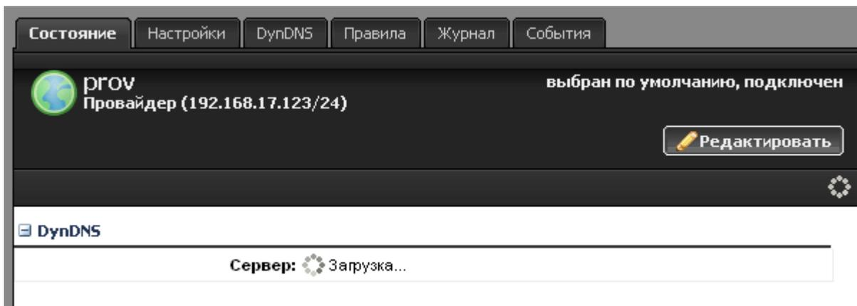
Чтобы перейти в настройки провайдера, вы можете нажать на кнопку «Подробнее...» или его имя в общем списке сетей. Откроется персональная страница сведений о данном провайдере. На первой вкладке отображается общее состояние провайдера и сведения о его **DynDNS-сервере**.
