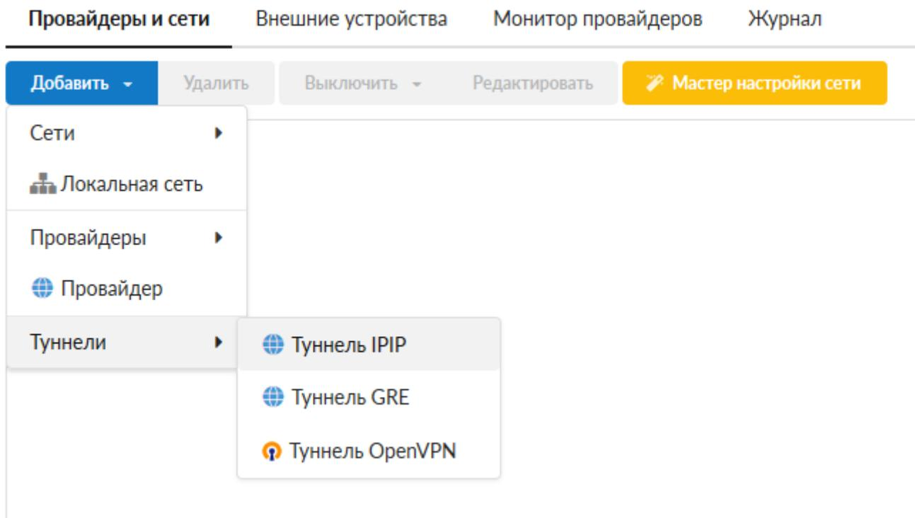
Обычно выбор типа туннеля зависит от промежуточных провайдеров, которые по каким-либо причинам они могут блокировать трафик GRE или IP/IP что приводит к невозможности использования какого-то одного типа туннеля. Принципиальной же разницы между этими типами туннелей нет.
