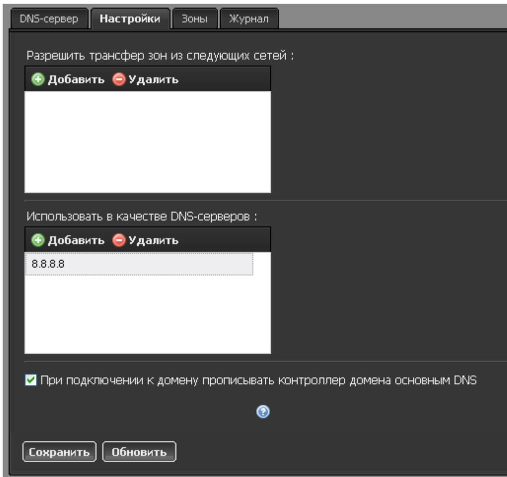
Основной внешний параметр DNS-сервера - список разрешений для трансфера зон. Сюда добавляются адреса других DNS-серверов, которые имеют право получать записи зон от ИКС.
