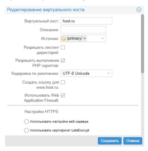
Для включения/выключения фильтрации трафика необходимо установить соответствующий флажок при добавлении или редактировании «Виртуального хоста»/«Виртуального хоста с перенаправлением», расположенных в Меню «Файловый сервер» - «Веб» - вкладка «Вебресурсы». Стоит отметить, что Веб-сервер должен быть настроен и запущен/
